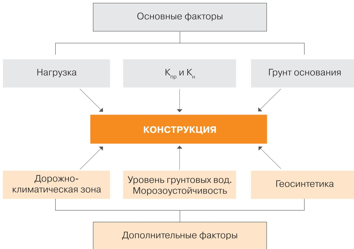
**Рисунок 12.** Факторы, определяющие вид конструкции
