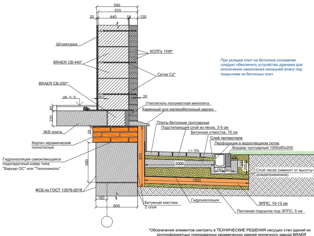
**Рисунок 35.** Конструкция отмостки полужесткого типа с бетонным лотком и теплоизоляцией.
