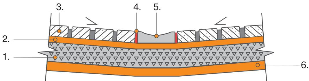
1 - Основание; 2 - Подстилающий слой; 3 - Пли бетонные тротуарные; 4 - Заполнение швов водонепроницаемыми растворами на основе трассово-цементного вяжущего; 5 - Водоотводной лоток Б1.18.50; 6 - Уплотненный грунт
