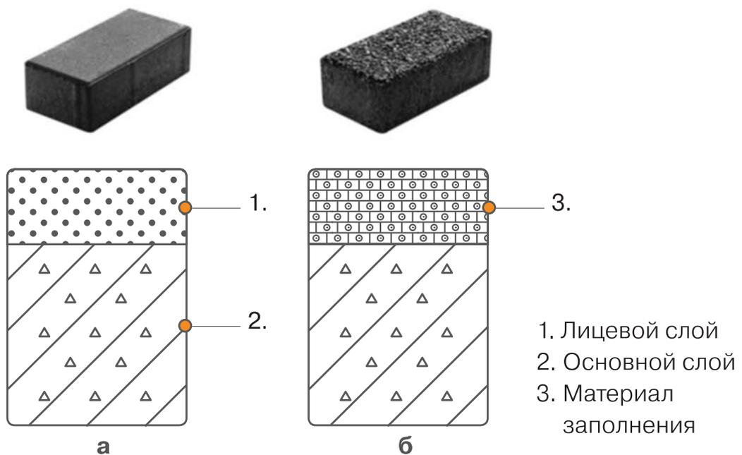
**Рисунок 4.** Общий вид и поперечный разрез плит бетонных тротуарных с гладкой (а) и размытой (фактурной) лицевой поверхности (б)
