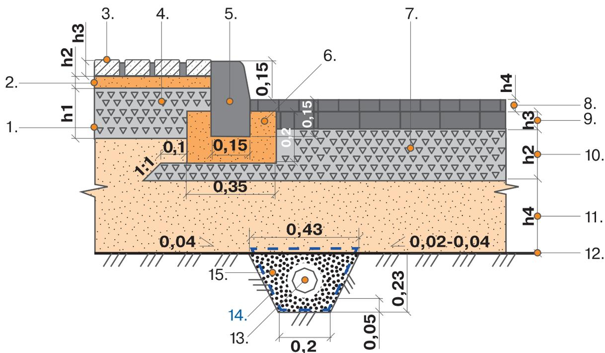
1 - Щебень; 2 - Подстилающий слой; 3 - Плиты бетонные тротуарные; 4 - Конструкция тротуара; 5 - Бордюр дорожный БР100.30.15; 6 - Бетон класса В15; F150 по ГОСТ 26633; 7 - Конструкция проезжей части; 8 - Мелкозернистый а/б; 9 - Крупнозернистый а/б; 10 - Щебень, уложенный по способу заклинки; 11 - Песок; 12 - Уплотненный грунт; 13 - Турбофильтр; 14 - Геотекстиль нетканый иглопробивной плотностью не менее 250 г/м<sup>2</sup>; 15 - Щебень
