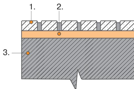
1 - Плиты бетонные тротуарные
