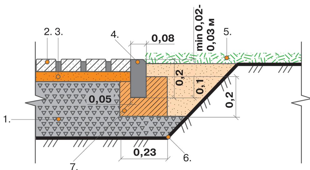
1 - Основание; 2 - Плиты бетонные тротуарные; 3 - Подстилающий слой; 4 - Бордюр тротуарный; 5 - Плодородный слой почвы (газон); 6 - Уплотненный грунт; 7 - Бетон класса В15; F150 по ГОСТ 26633
