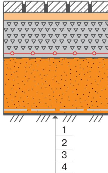
**Рисунок 23.** Конструктивная схема дорожной одежды с покрытием из плит бетонных тротуарных BRAER Группы ВII
