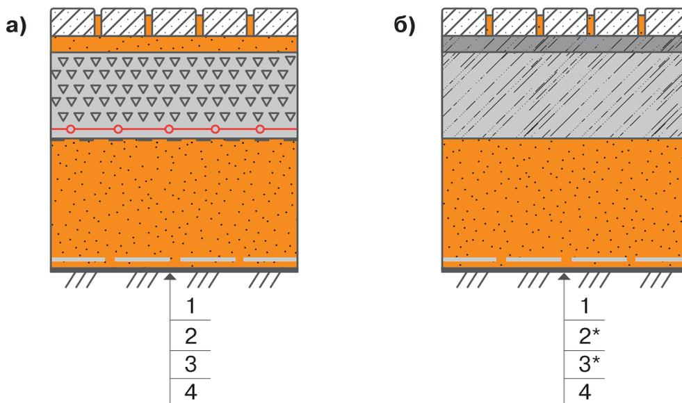
**а)** Конструктивная схема дорожной одежды нежесткого типа;
