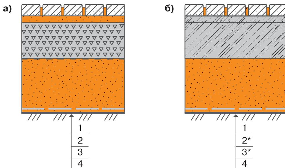
**а)** Конструктивная схема дорожной одежды нежесткого типа;
