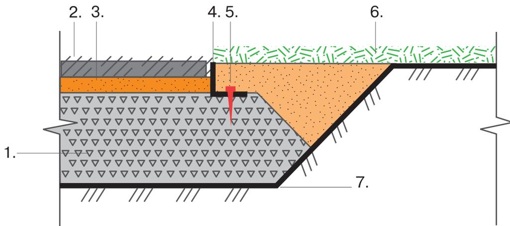
1 - Основание; 2 - Плиты бетонные тротуарные; 3 - Подстилающий слой;
