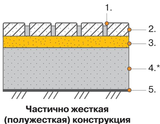
1 – швы, заполненные песком; 1\* – швы, заполненные песком с обработкой стабилизатором; 2 - плиты бетонные тротуарные; 3 - подстилающий слой из песка; 3\* - подстилающий слой из дренажного раствора; 4 - несущий слой; 4\* - несущий слой из цементобетона; 5 - земляное полотно.
