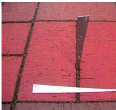
**Рисунок 40.** Измерение ширины шва при восстановлении покрытия
