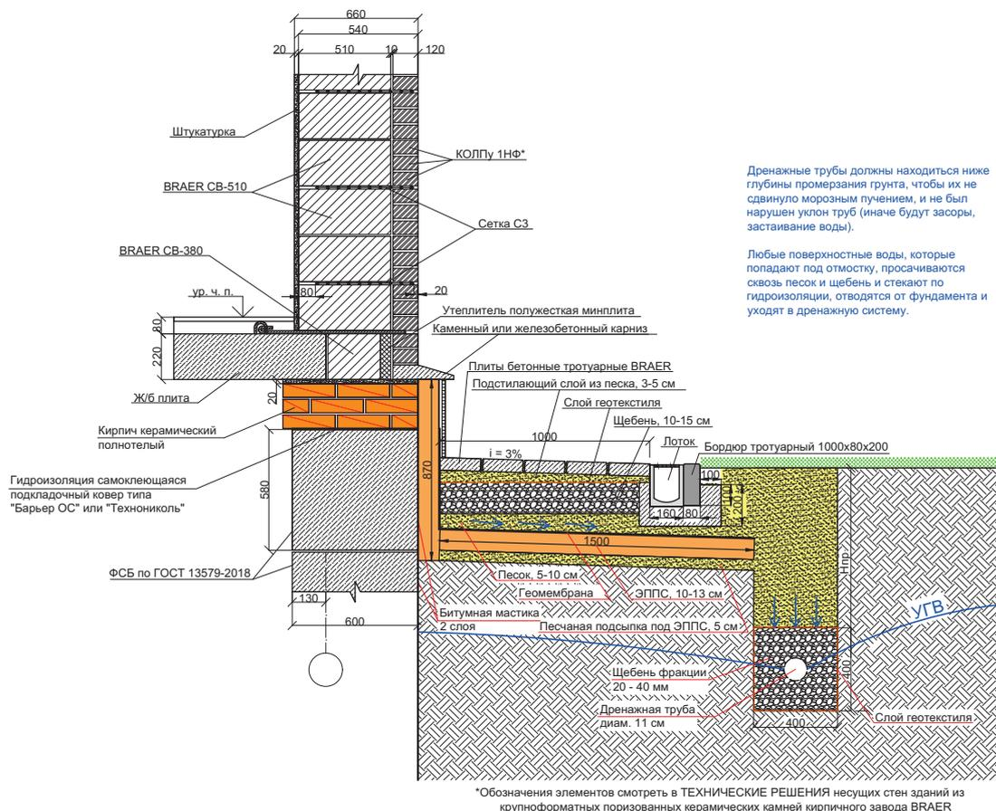
**Рисунок 37.** Конструкция отмостки нежесткого типа с водоотводным лотком, дренажной системой и теплоизоляцией.
