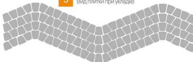
3 Вид плитки при укладке
